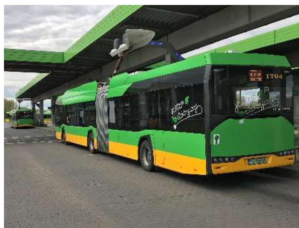
Rys. 4.1 Autobusy elektryczne akumulatorowe typu MEGA18 w Poznaniu podczas szybkiego ładowania
