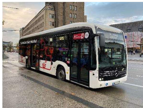
Rys. 4.2 Autobus elektryczny akumulatorowy typu MAXI przystosowany do ładowania wyłącznie techniką plug-in w Aachen (Niemcy)
