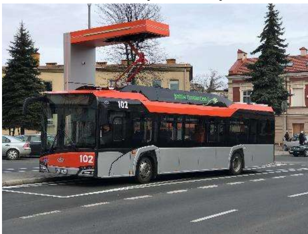
Rys. 7.1 Autobus elektryczny akumulatorowy na stacji szybkiego ładowania w Rzeszowie
