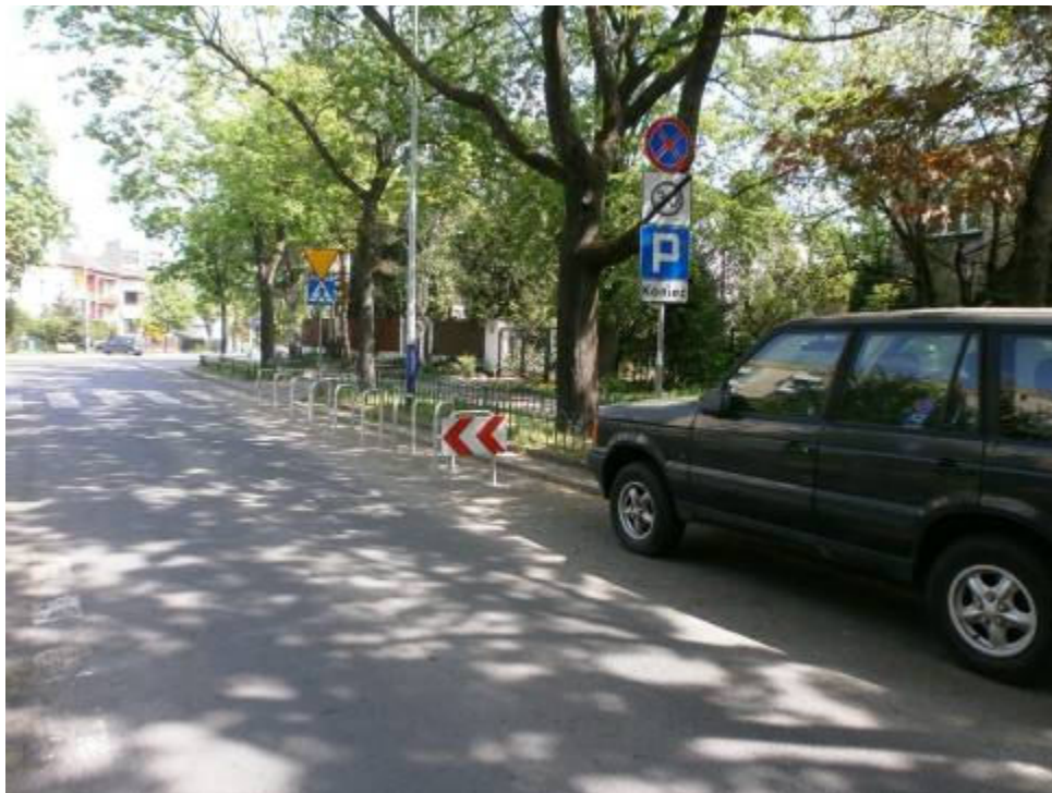
Fot. 8 Skracanie zatok parkowania i zwężanie przekroju jezdni ulicy przed skrzyżowaniami przy pomocy stojaków rowerowych
