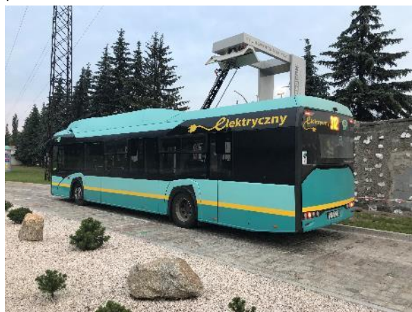
Rys. 4.3 Autobus elektryczny akumulatorowy Solaris Urbino 12 electric w barwach PKM Jaworzno
