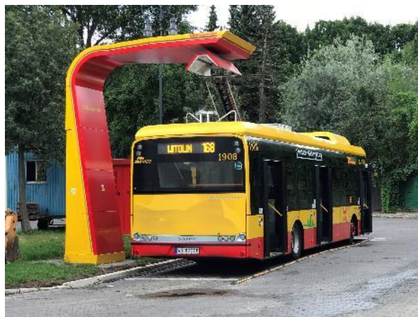
Rys. 4.4 Ładowarka pantografowa i autobus elektryczny akumulatorowy Solaris Urbino 12 electric w malowaniu ZTM Warszawa
