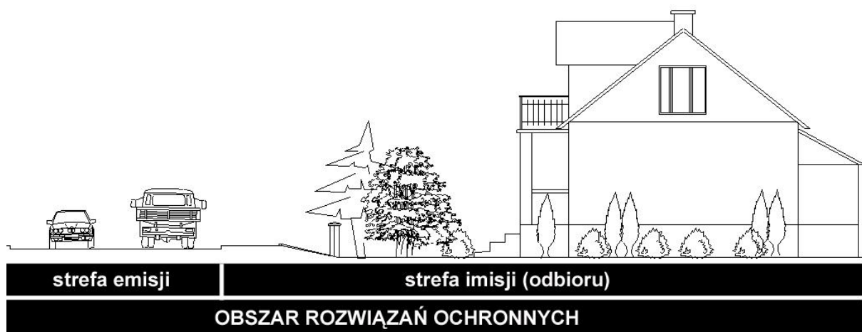
Rys. 6.8. Strefy emisji i imisji hałasu oraz obszar rozwiązań ochronnych w uniwersalnym podejściu do ochrony przed hałasem drogowym
